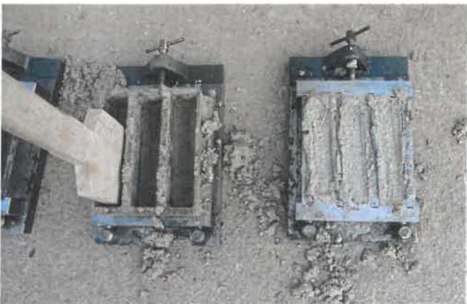
Die Biegezugfestigkeit des verwendeten Estrichmörtels wurde an den Mörtelprismen nach DIN EN 13892-2 mit 7 N/mm 2 erreicht.
