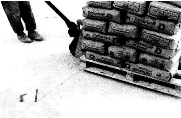
Auf der Palette sind 800 kg Belastung vorhanden. Mit dem Handhubwagen werden auch dynamische Kräfte und im Besonderen extreme Punktlasten erzeugt. Nach der Normprüfung entspricht der Estrich der Festigkeitsklasse ZE 12.
