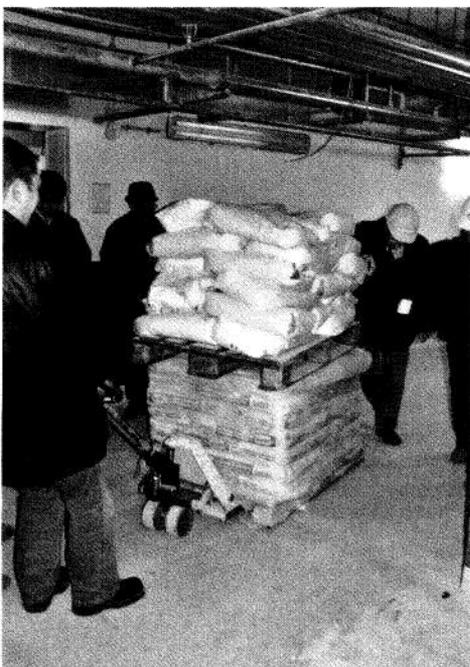
Die Auflast von über 1 t verursacht unter Einsatz eines Handhubwagens extreme Beanspruchungen am Estrich. Auch bei dieser extremen Belastung entstanden keine Esticheinbrüche.
